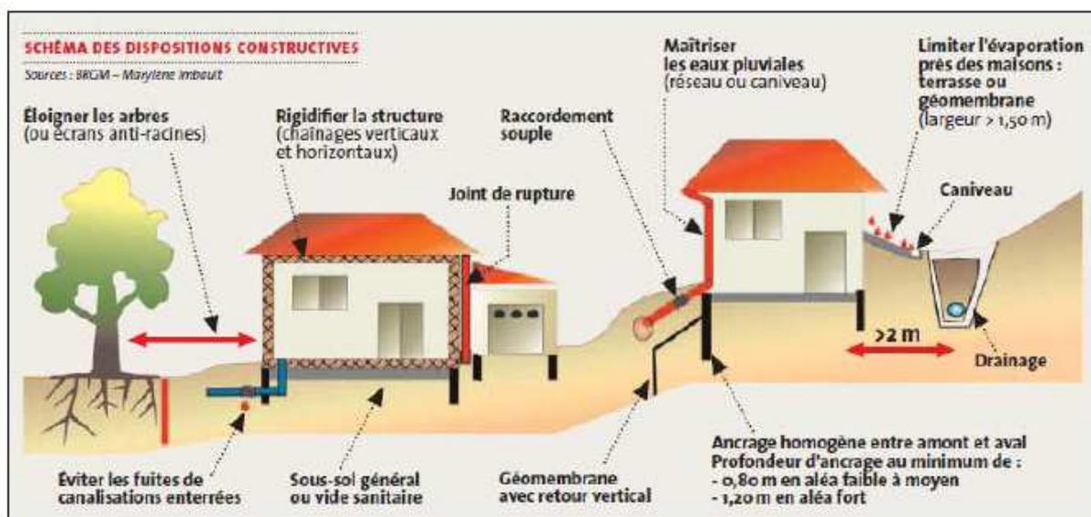
Illustration 8 : Schéma synthétique des dispositions constructives (www.georisques.gouv.fr)
